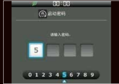
发动机启动密码设置功能 可设置发动机启动密码，增强安全性。首次需要在经销商处进行密码设置。
