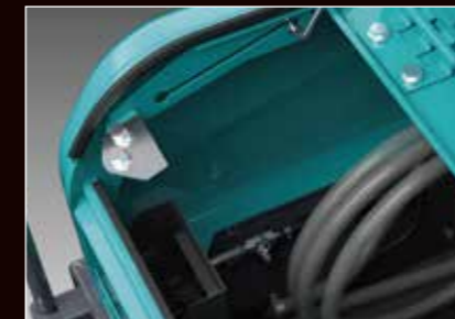
远程柴油排水阀 在工具箱内安装柴油箱远程排水阀。轻松触及，排出柴油箱内的液体。
