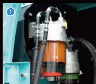
带油水分离功能的燃油预滤芯
