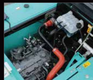
发动机维修保养 宽幅发动机机盖， 可轻松接触到发动机部件。
