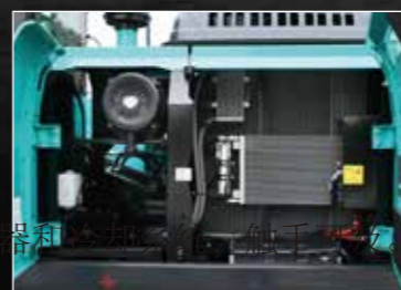
左侧舱室 散热器和冷却系统，触手可及。
