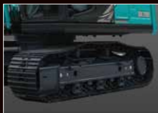
增强型履带校正器(单侧3个) 防止在恶劣的矿山现场的链轨脱落。 ※选配
